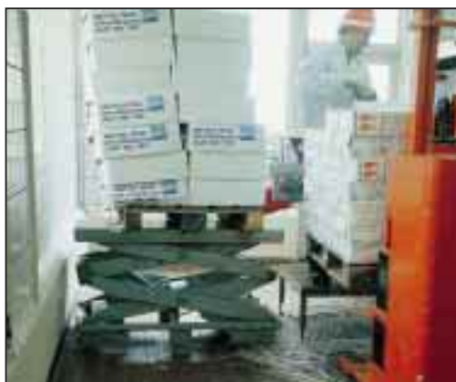
Cette table à doubles ciseaux du type EV10-188G et 1 tonne de capacité, permet dans une usine de produits alimentaires de manutentionner un grand nombre de palettes sans maux de dos. Table ergonomique.
