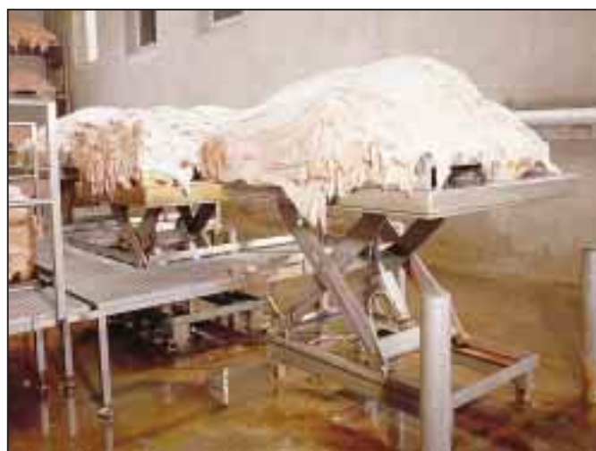
Une série de tables élévatoires du type EL12-95SS à 1200 kg de capacité aide à traiter les peaux saumurées dans cet abattoir. Le lourd labeur manuel nécessite une hauteur de travail adaptée afin d'éviter les maux de dos et pour pouvoir supporter le rythme de travail. Seul l'acier inoxydable AISI316 peut résister aux circonstances corrosives, causées par l'abondance d'eau et de sels.
